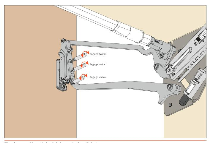
**Fixation supplémentaire à faire après les réglages.**En cas d'utilisation de portes avec profilé en aluminium, remplacer la vis indiquée par celle fournie dans le sachet avec l'adaptateur DBZXBH9.
